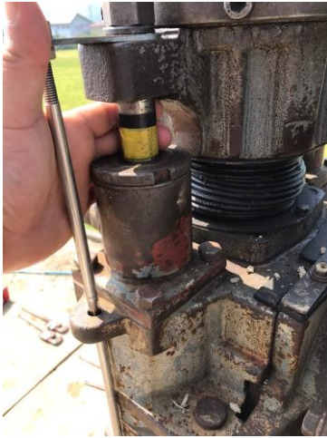
写真-1 はさまれ箇所(着色部)
